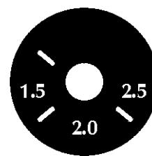
Potentiometrissä numeroin 1.5, 2.0, 2.5 merkityt asennot ilmaisevat optimaalisen virran asetusta sekä hitsausta 1.5, 2.0, 2.5 mm:n elektrodeilla.
