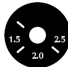
Les positions mises en évidence sur le potentiomètre avec les chiffres 1,5, 2 et 2,5 indiquent que le courant est réglé de façon optimale et la soudure des électrodes de 1,5, 2 et 2,5 mm.
