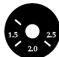
As posições evidenciadas no potenciómetro com as escritas 1.5, 2.0, 2.5 indicam a definição de corrente óptima e a soldadura dos eléctrodos de 1.5, 2.0, 2.5 mm.
