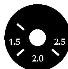
Lägena 1,5, 2,0 och 2,5 på potentiometern anger optimal ströminställning och svetsning med elektroder på 1,5, 2,0 och 2,5 mm.
