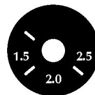
Las posiciones indicadas en el potenciómetro con 1.5, 2.0, 2.5 indican la configuración de corriente ideal y la soldadura de los electrodos de 1.5, 2.0, 2.5 mm.
