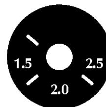
Le posizioni evidenziate sul potenziometro con le scritte 1.5, 2.0, 2.5 indicano l'impostazione di corrente ottimale e la saldatura degli elettrodi da 1.5, 2.0, 2.5 mm.
