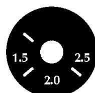
De met 1.5, 2.0, 2.5 op de potentiometer aangegeven posities geven de optimale stroom en het lassen van elektroden van 1.5, 2.0, 2.5 mm aan.
