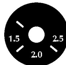
Stillingene som er merket med 1.5, 2.0, 2.5 på potensiometrene angir optimal strømsinnstilling og optimal sveising for elektrode-ne fra 1.5, 2.0, 2.5 mm.
