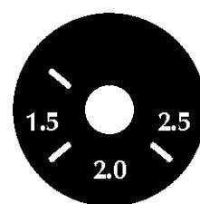
De fremhævede positioner på potentiometeret, med påskriften 1.5, 2.0 og 2.5, angiver den optimale strømindstilling og elektrodesvejsning på 1.5, 2.0 og 2.5 mm.
